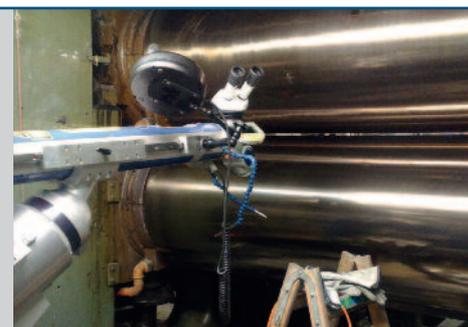
Soldadura de reparación de un rodillo (Foto: tcms, Gummersbach)
