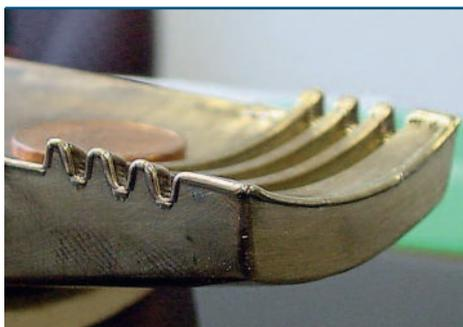
Restauración de los contornos de un elemento de un molde de Ampco - Bronce (Foto: L&A Lasertechnik, Radebeul)
