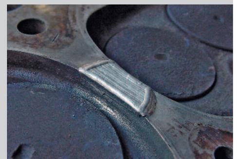
Reparatur eines wassergekühlten Zylinderkopfes aus Aluminium (Foto: L&A Lasertechnik, Radebeul)
