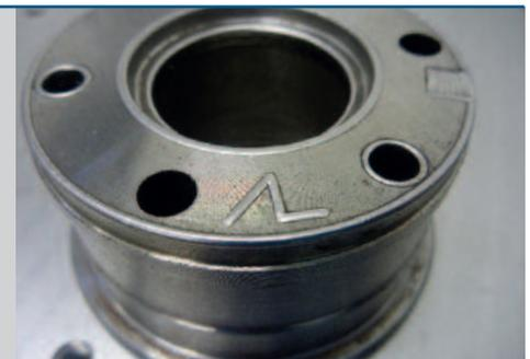
Reparación de un canto defectuoso de un molde de inyección
