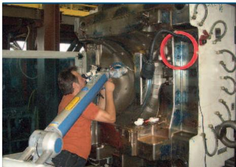
Reparación de soldadura móvil directamente en un molde de inyección (Foto: Jutz Lasertechnik)
